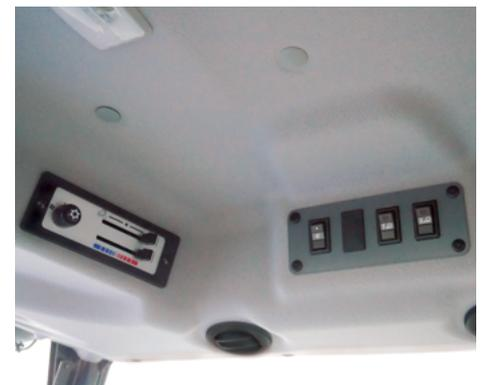
Cabina con aire acondicionado y una gran cantidad de ventilaciones para una distribución óptima del aire
