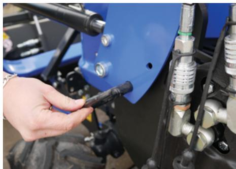
**Cargador/desacople instantáneo cargador/tractor**
