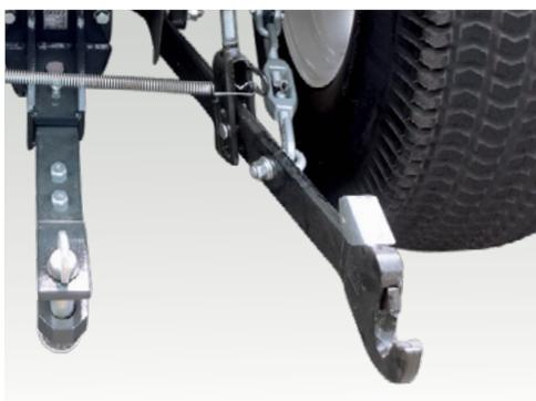
Elevación trasera 3 puntos con ganchos para un acoplamiento simple y rápido de las herramientas
