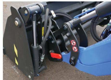
**Acoplamiento automático cargador/herramienta\***
