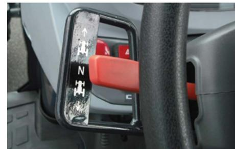
El inversor de desplazamiento (sistema electrohidráulico) permite cambiar de marcha adelante a atrás sin tener que para presionar el embrague
