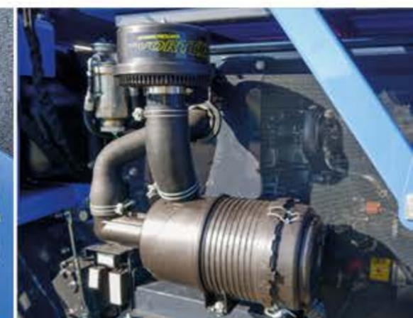
FILTRACIÓN MUY EFICIENTE El uso de un prefiltro Vortex combinado con el filtro de aire, permite aportar un flujo de aire perfectamente limpio al motor, para una mayor duración de la vida útil.
