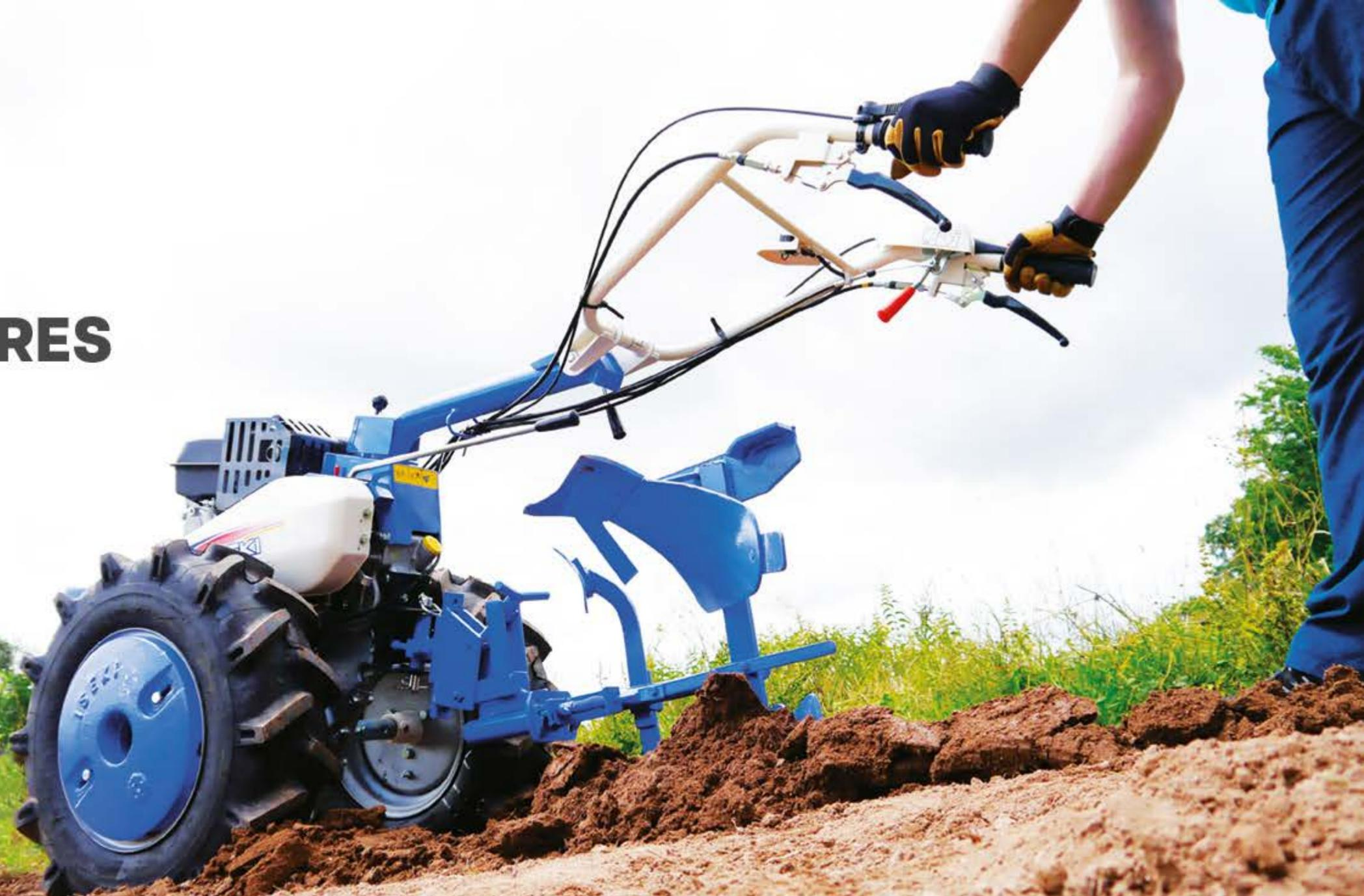
El motocultor SA603 cubrirá todas sus necesidades gracias a sus variados equipamientos, y las 2 motoazadas le demostrarán que es posible tener una máquina de calidad a un precio competitivo. En cuanto a la motofresa KCR703, equipada con un sistema de contra-rotación de las fresas, le permitirá obtener un acabado perfecto de su terreno.
