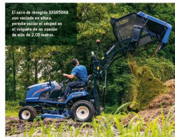
El saco de recogida SXG650HA con vaciado en altura, permite vaciar el césped en el volquete de un camión de más de 2.05 metros.
