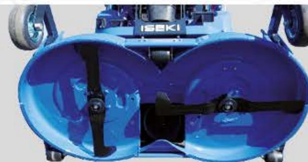
SF2137: plataforma de corte de 137 cm con 2 cuchillas sincronizadas montadas sobre pasadores de seguridad
