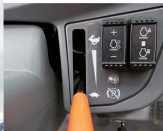
**CONTROL DE LA MEMORIZACIÓN Y AJUSTE DEL RÉGIMEN DEL MOTOR**
