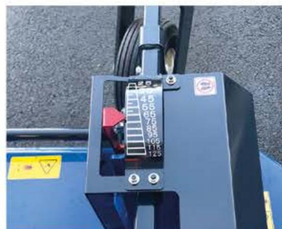
REGULACIÓN ELECTROHIDRÁULICA DE LA ALTURA DE CORTE
