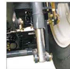
ELEVACIÓN MEDIANTE CILINDROS DE GRANDES DIMENSIONES
