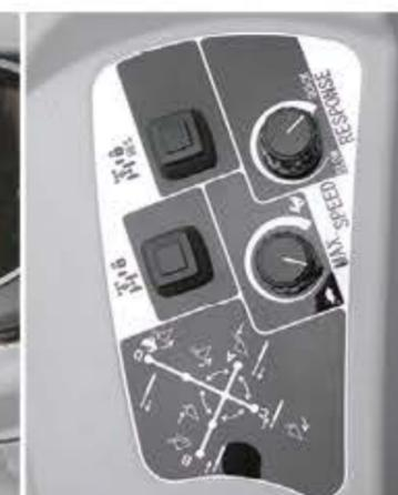
2 POTENCIÓMETROS DE AJUSTE DE LA VELOCIDAD
