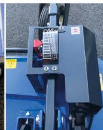
AJUSTE ELECTROHIDRÁULICO DE LA ALTURA DE CORTE
