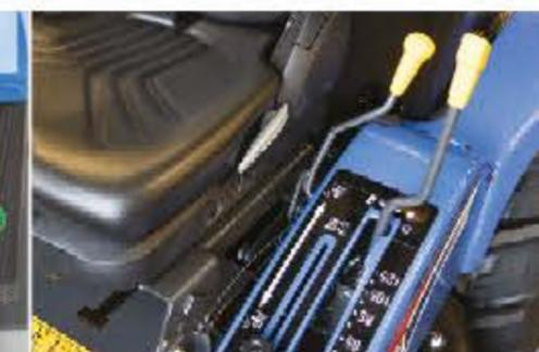
**PALANCA DEL EMBRAGUE DE LA TRANSMISIÓN**
