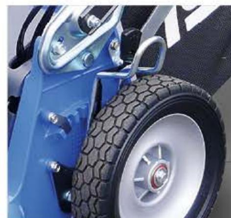
**AJUSTE DE LA ALTURA DE CORTE** de hasta 7 posiciones por eje, para adaptarse perfectamente a cualquier terreno
