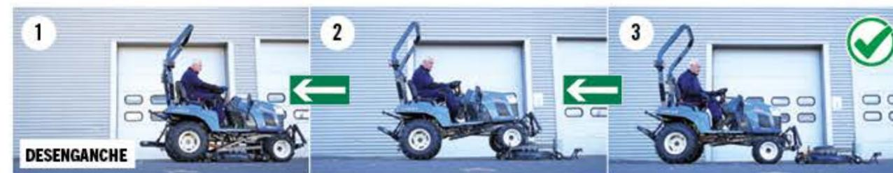
Con el nuevo sistema de montaje "Drive Over", la plataforma de corte se puede acoplar y desacoplar muy rápidamente, lo que brinda más versatilidad a este tractor.
