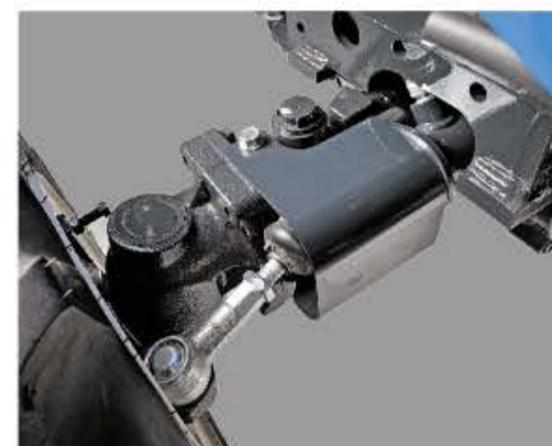
PROTECCIÓN DE LOS CILINDROS DE DIRECCIÓN
