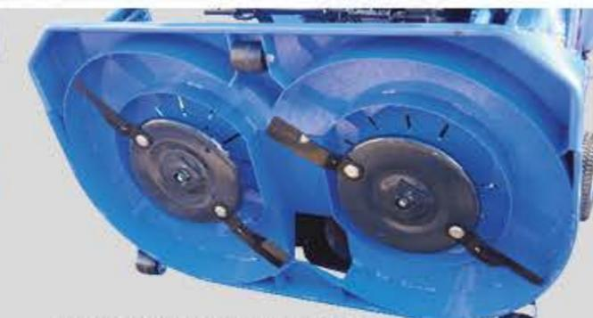
SF2152: plataforma de corte de 152 cm con 2 x 2 cuchillas retráctiles montadas sobre portacuchillas
