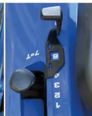
SISTEMA DE MEMORIA DEL AJUSTE DE LA ALTURA DE CORTE (SXE222+, SXE224+, opcional en los demás modelos)
