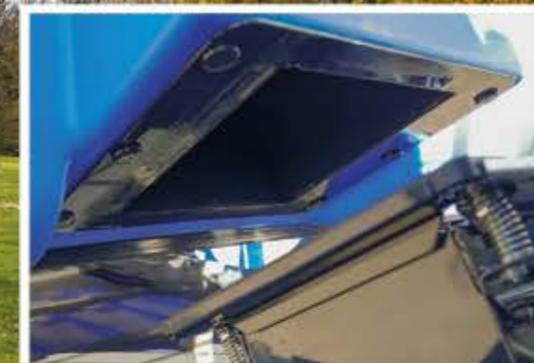
El saco y el canal de expulsión se superponen perfectamente, gracias a una placa de goma montada sobre muelles que asegura la perfecta estanqueidad de los dos elementos.
