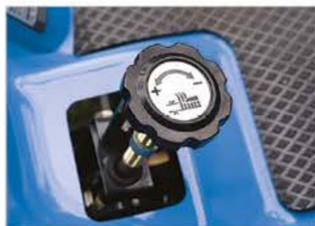
**AJUSTE PRECISO DE LA ALTURA DE CORTE**
