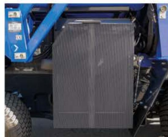
GRAN REJILLA DE FILTRACIÓN EXTRAÍBLE para la refrigeración de la transmisión, los accesorios y el motor
