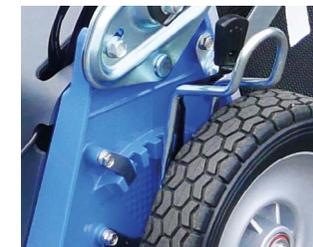
Ajuste de corte por eje totalmente protegido
